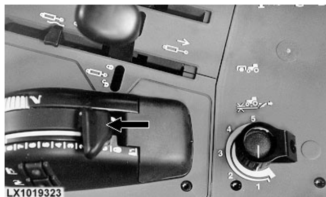
A—Palanca de control del elevador B—Interruptor de elevación/descenso C—Ajuste del límite de elevación
