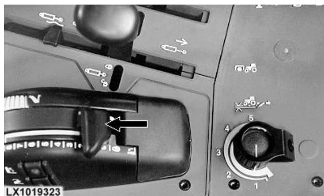
A—Manette de réglage de la profondeur de travail B—Contacteur de commande du relevage C—Bouton de limitation de la hauteur de levage
