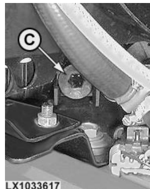
A—Bouchon de remplissage B—Dispositif de branchement/débranchement (avant du radiateur) C—Vis de vidange (arrière du radiateur)
