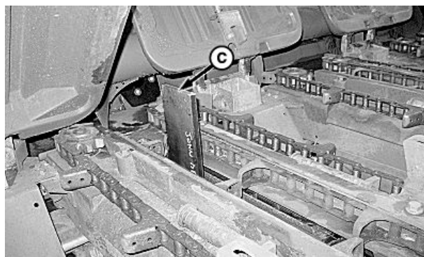
Zobrazena demontáž levé přídržné matice
