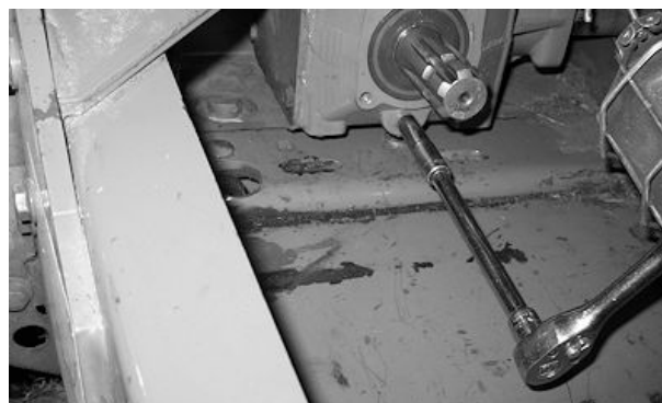
Retiro del tapón de vaciado
