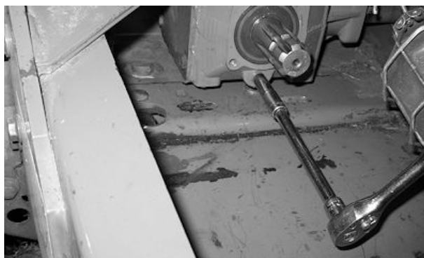
Retiro del tapón de vaciado
