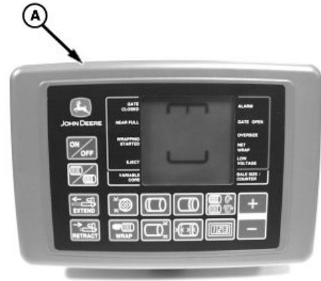
A—Controlador del monitor
