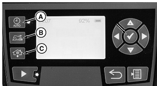
A—Mode Tonte programmée (AUTO) B—Mode Tondre maintenant C—Mode Retour à la station de recharge
