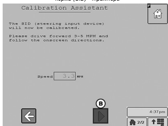
Калібрування пристрою визначання зусилля, прикладеного до керма (SID) - валкові жнивarki
