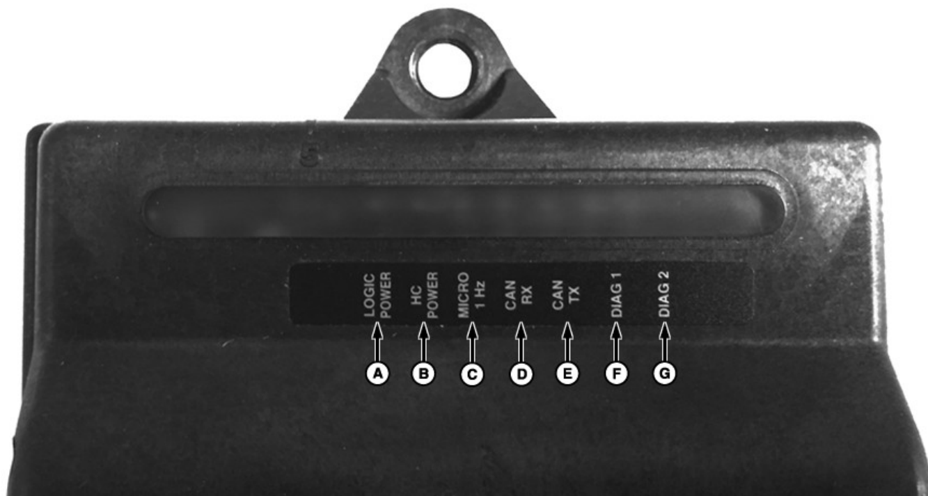
LED dell'unità di comando dello sterzo Raven
