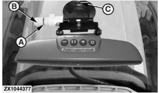
А—Красная линия В—Поршень насоса
