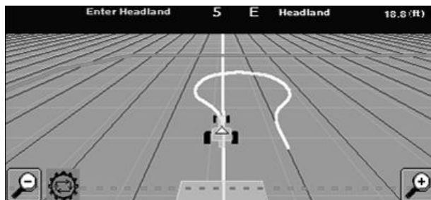
Întoarcere simetrică de tip bec (Punct de control la 0 m (0 ft) sau cu un cuplaj cu prindere în trei 3) (Raza de bracăj este mai mare decât jumătate din Ecartament)
