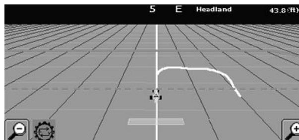
Curva Simples Estendida (Raio da Curva é Menor que Metade do Espaçamento da Pista)
