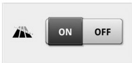
PC28780—UN—25AUG22 Sekciju vadības galvenais slēdzis
