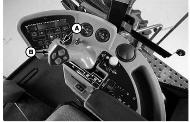
İç Devam Anahtarı — Yalnızca W110 ve W150 Hasat Makineleri
