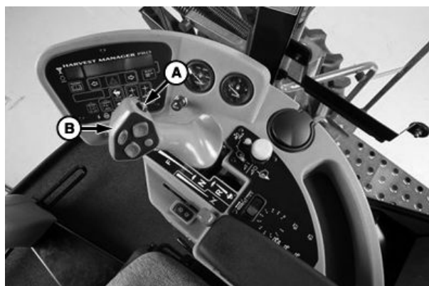
Touche de retour automatique interne—Faucheuses-andaineuses W110 et W150 uniquement
