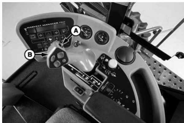
Interní spínač obnovení činnosti pouze pro řádkovače W110 a W150
