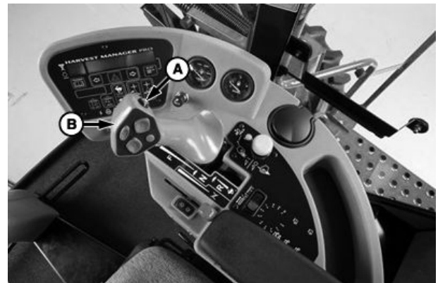
Interný spínač obnovenia – len riadkovače W110 a W150
