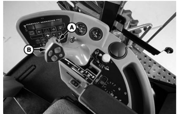
Interruptor de reanudación interno (solamente con hileradoras W110 y W150)
