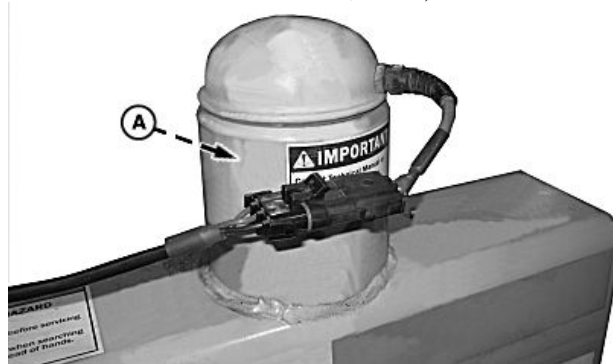
Senzorul de unghi al roților încorporat
