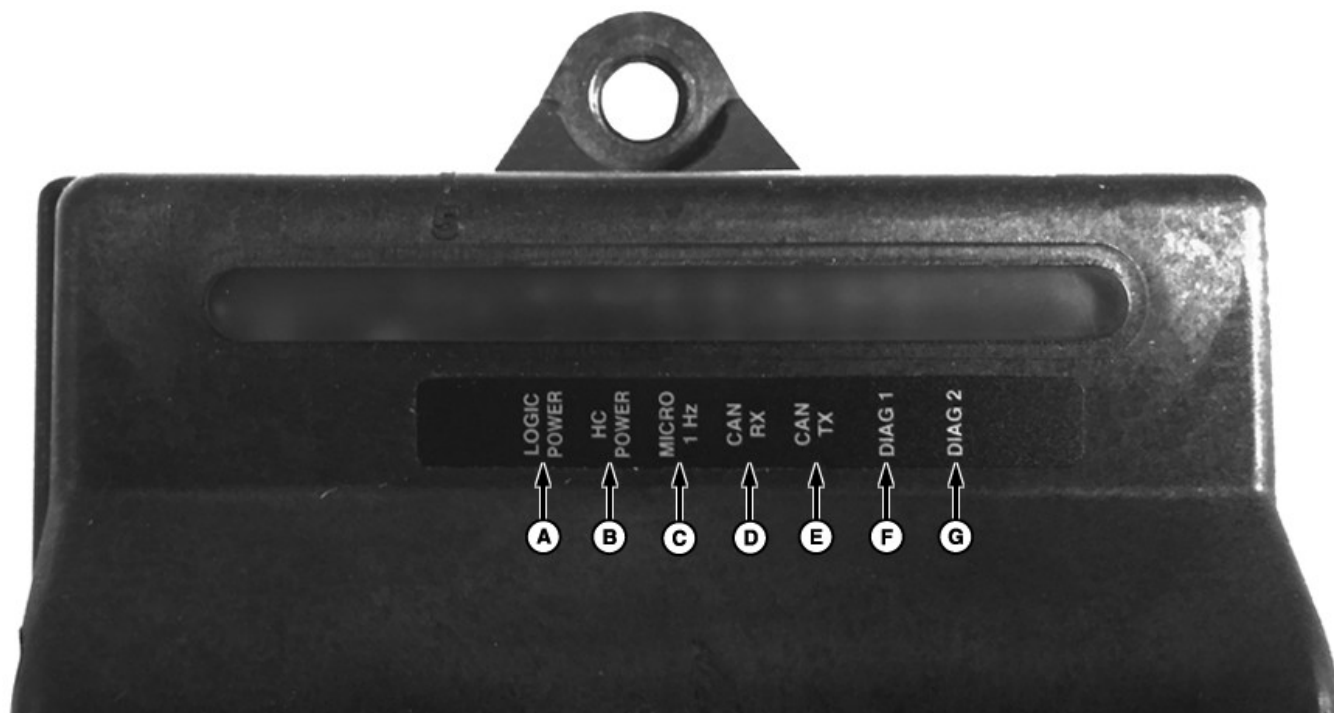
LED lampice za Raven kontroler upravljanja
