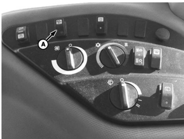
Spínač obnovení činnosti v traktoru
