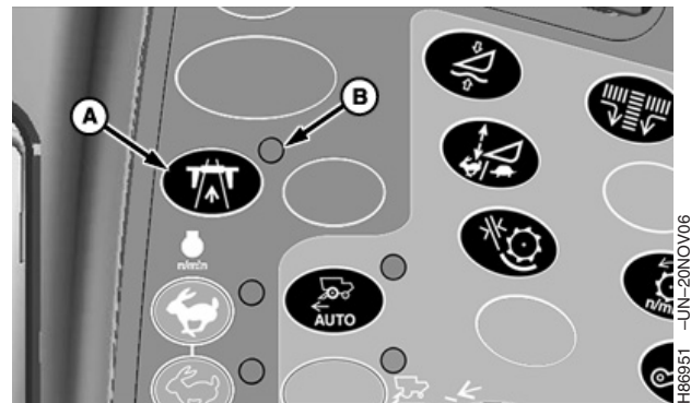
A—Sectionneur de transport sur route B—Témoin lumineux
