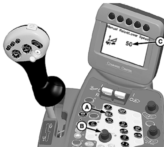
A—Contacteur de réglage de la vitesse de réponse/sensibilité de la chambre d'alimentation B—Cadran de sélection
