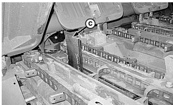
Dépose de l'écrou de fixation gauche
