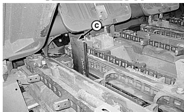
拆卸图中所示左侧锁紧螺母
