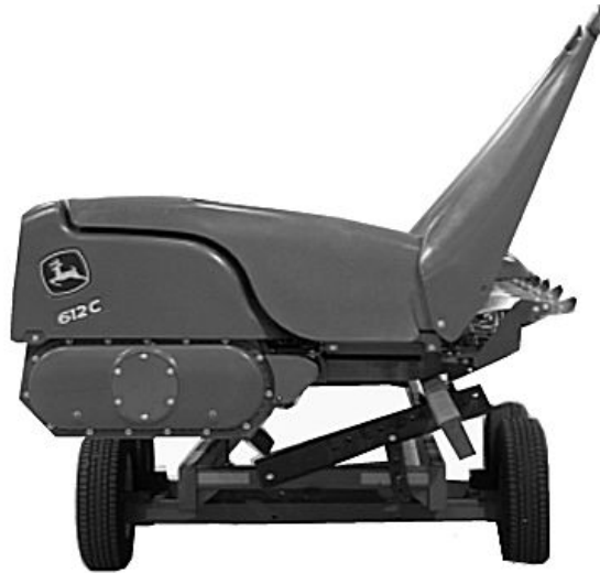
Abbildung zeigt Stängelteilerspitzen für den Transport eingeklappt
