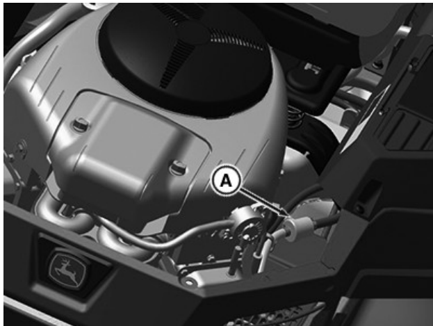
Alapkitelű kéthengeres motort.
