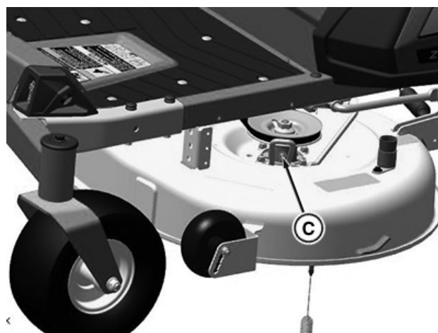
Odstranjevanje pokrova levega vretena
