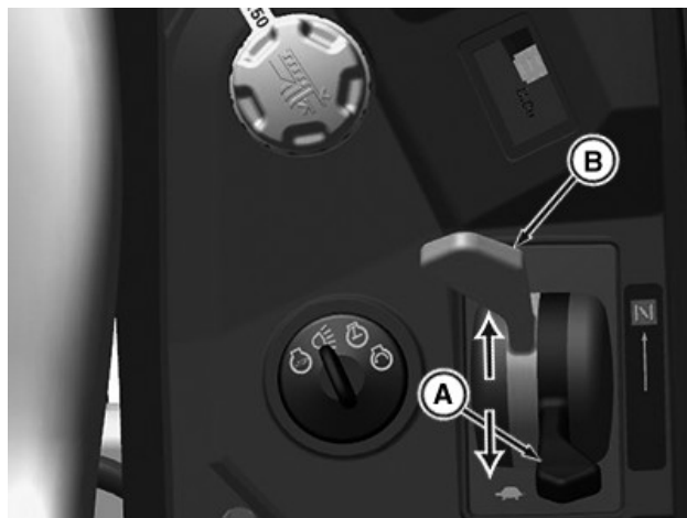
GX535573—UN—07JUN22 Dźwignia podwójna w modelach Z320R i Z320M
