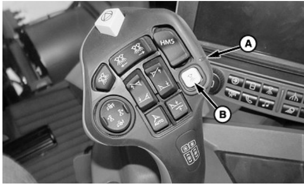
A—Témoin B—Contacteur de démarrage du système d'épandage
