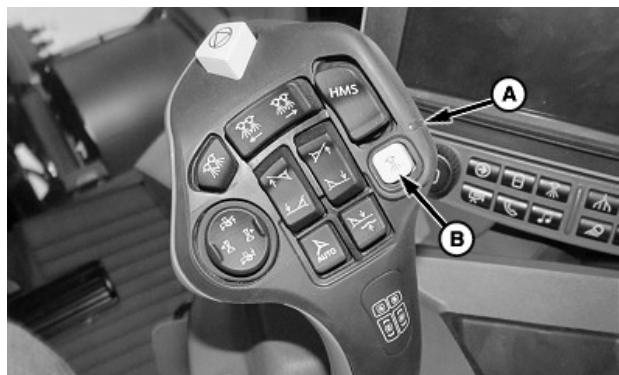
A—Témoin B—Contacteur de démarrage du système d'épandage
