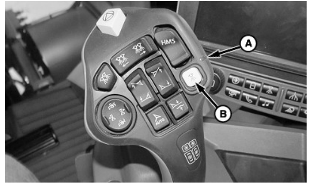
A—Témoin B—Contacteur de démarrage du système d'épandage
