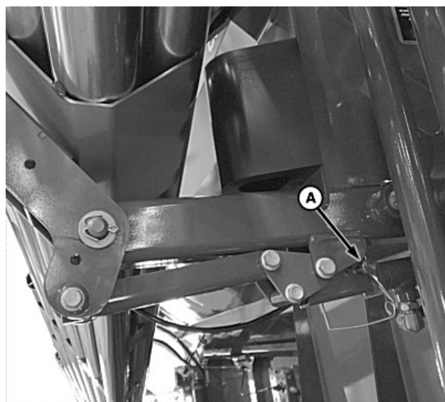
A—Verrouillage manuel de la rampe de pulvérisation
