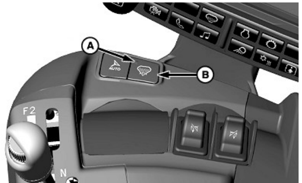
A—Témoin B—Contacteur de démarrage du système d'épandage
