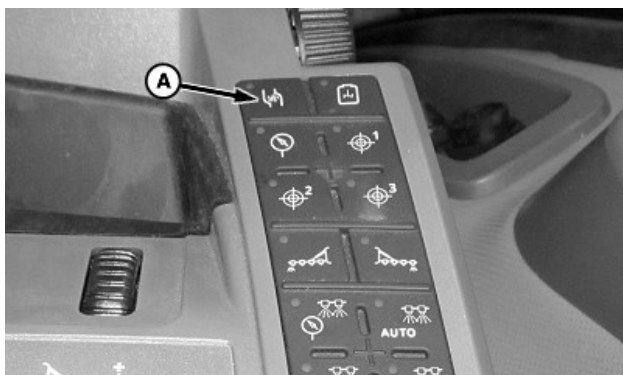
A—Touche d'activation hydraulique
