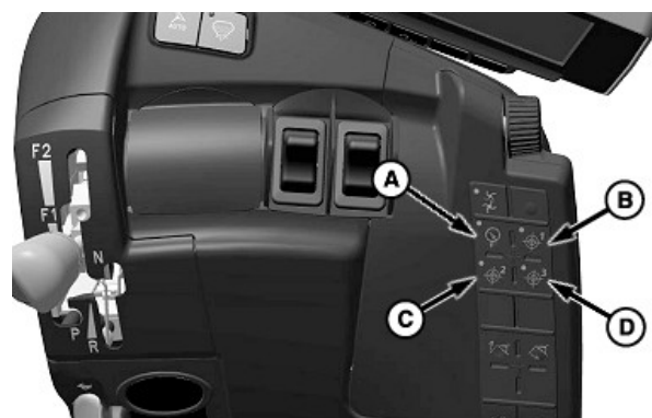
A—Botón de selección de dosis manual B—Botón de selección de la dosis preajustada 1 C—Botón de selección de la dosis preajustada 2 D—Botón de selección de la dosis preajustada 3
