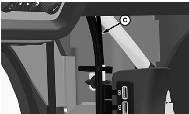
Câble d'alimentation/de mise à la masse de la radio derrière le couvercle du montant d'angle arrière
