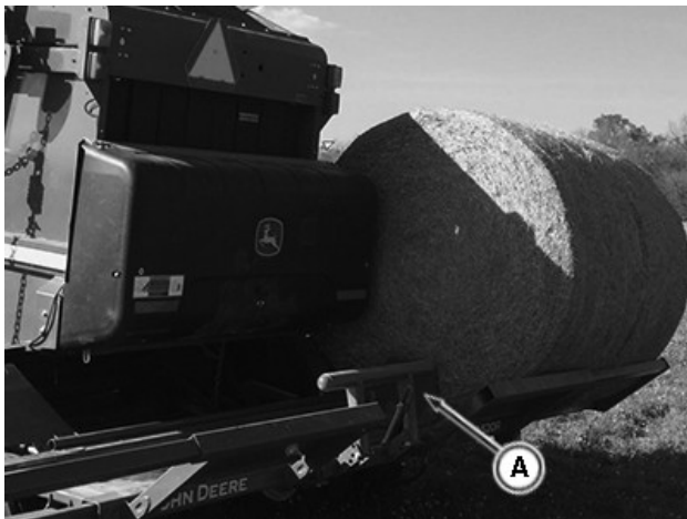
A—Posición de la barra deslizante del lado derecho (paca del lateral derecho)
