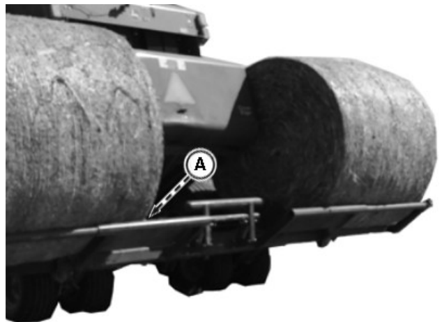
A—Tercera posición de la barra deslizante (cuando el portón de la empacadora se cierra)
