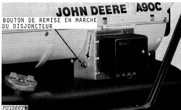
Bouton de remise en marche du disjoncteur
