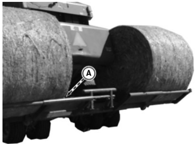
A—Troisième position du coulisseau (porte de la presse à balles fermée)
