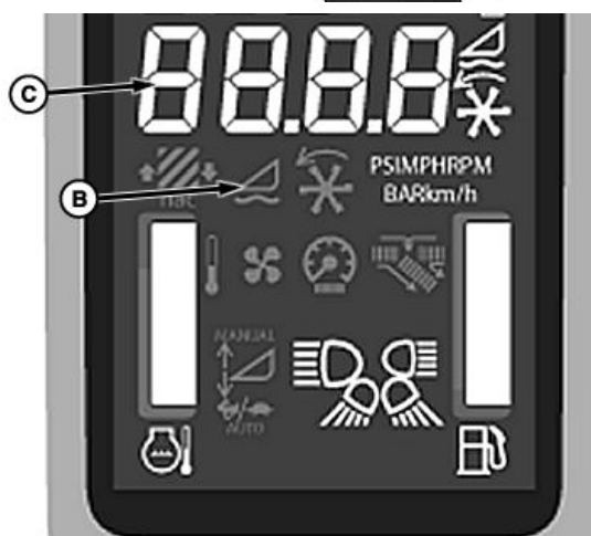
A—浮动压力调整开关（第二个锁定位置） B—浮动功能指示灯 C—浮动压力显示屏
