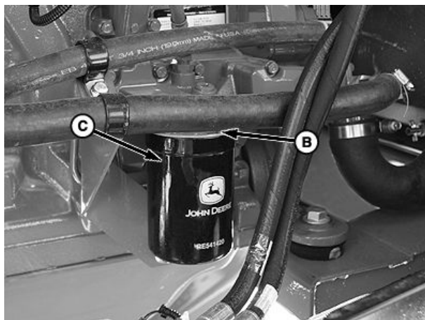
A—发动机机油排油塞 B—发动机机油滤清器座
