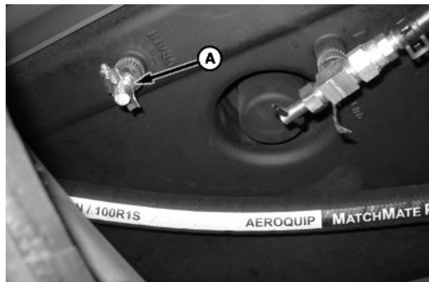
A—Grifo de vaciado de combustible
