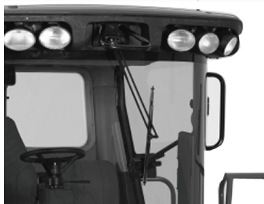
图示为标准风挡玻璃雨刷器
