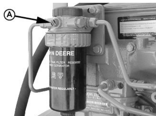
Vis de dégazage du filtre à carburant final
