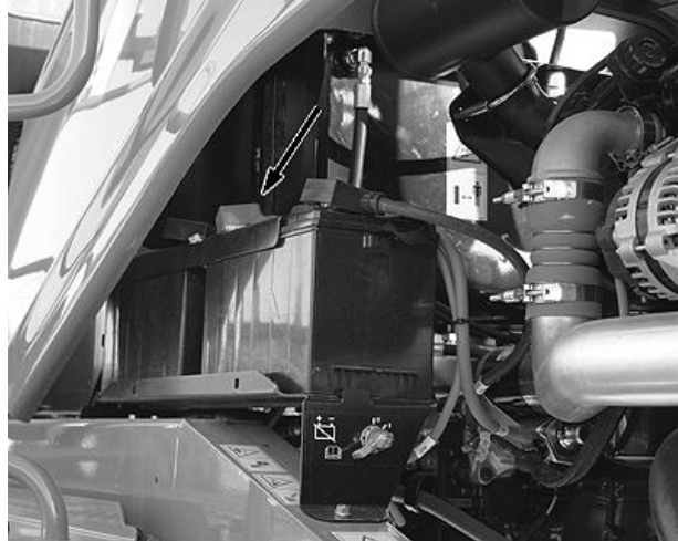
Baterías de W110
