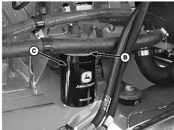
A—Tapón de vaciado de aceite motor B—Base del filtro de aceite motor C—Filtro de aceite motor
