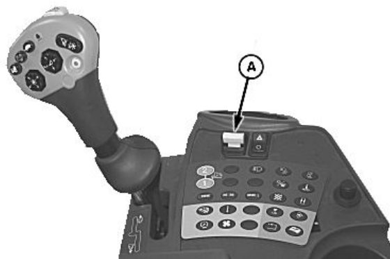
A—Engrane de la transmisión de la plataforma
