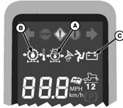
A—Luz de presión de aceite B—Luz de presión hidrostática
