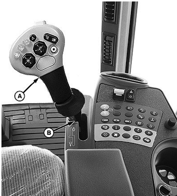
A—Palanca multifunción B—Posición de estacionamiento en punto muerto C—Palanca tensada por un muelle
