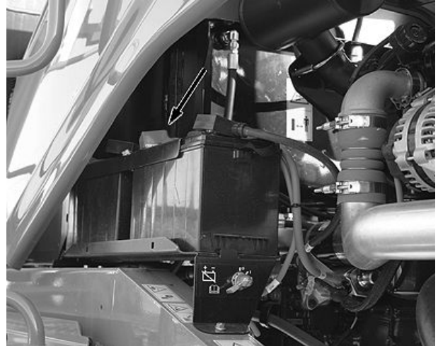
Baterías de W110
