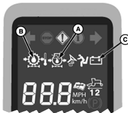
А—Лампочка давления масла В—Лампочка гидростатического давления
