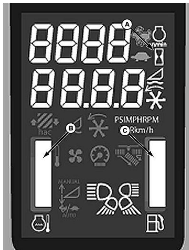
A—Compteur d'heures de service B—Indicateur de température
