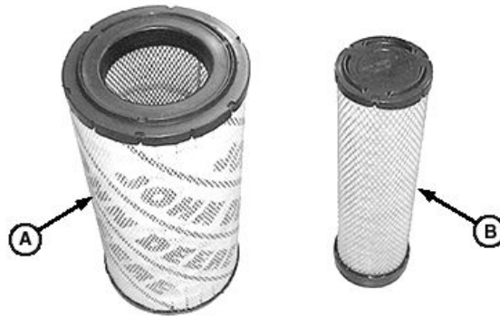
A—Élément principal du filtre à air B—Filtre à air auxiliaire
