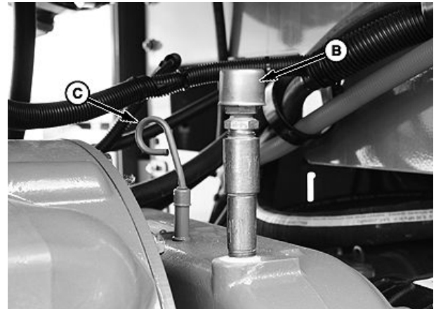
A—Raccord de flexible du boîtier B—Évent
