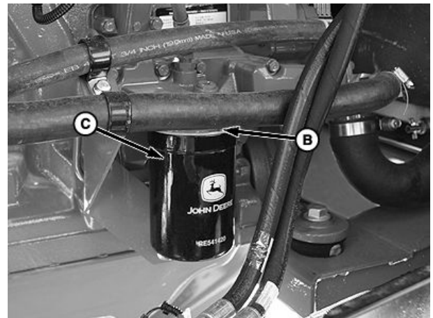
A—Bouchon de vidange d'huile C—Filtre à huile moteur B—Base du filtre à huile moteur
