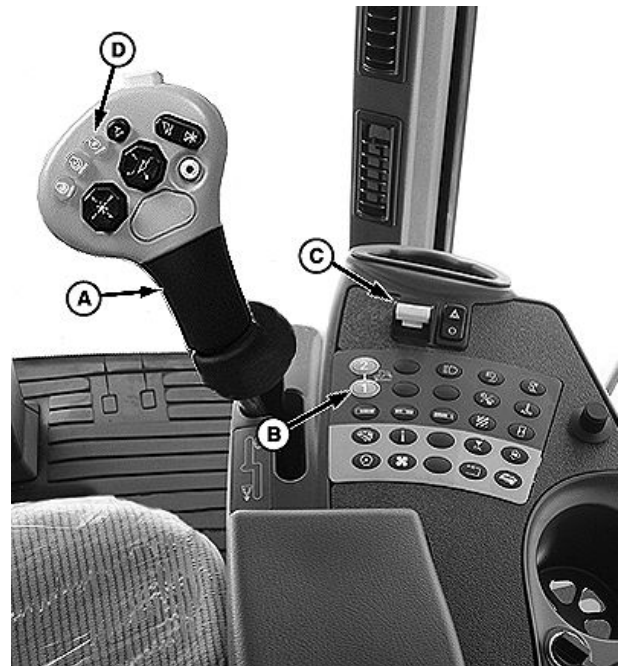
A—Lever multifonction B—Interrupteur de régime lent (1)
