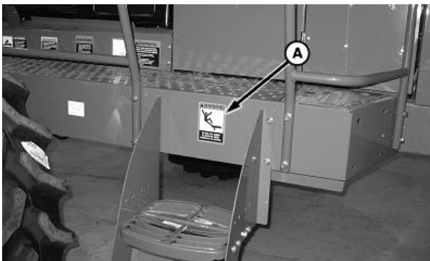
Marche de plate-forme de la cabine
