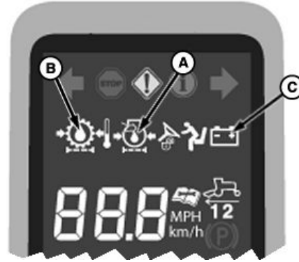
A—Témoin de pression d'huile B—Témoin de pression hydrostatique
