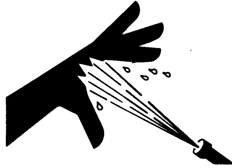
Conduites d'alimentation sous haute pression
