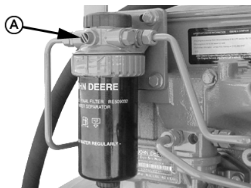
Tornillo de purga de filtro final de combustible
