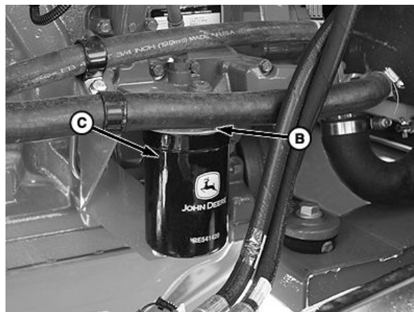
А—Сливная заглушка масла двигателя В—Основание масляного фильтра двигателя С—Масляный фильтр двигателя
