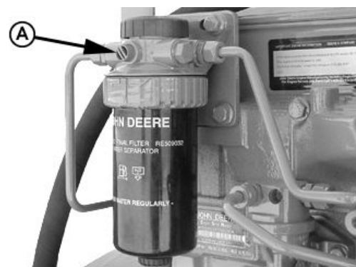
Винт для выпуска воздуха из топливного фильтра тонкой очистки
