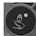
RXA0168434—UN—30MAY19 Botón de bloqueo del pedal del acelerador
