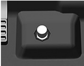
Comutatorul de pe podea pentru blocarea diferențialului
