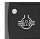
Butonul pentru mecanismul de blocare a diferențialului
