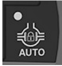
Buton pentru mecanismul de blocare automată a diferențialului
