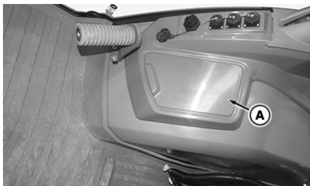
RXA0167377—UN—05APR19 În spatele panoului lateral (A) din partea dreaptă jos a scaunului operatorului
