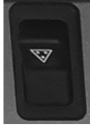
Comutator pentru luminile remorcii
