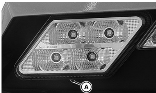
Lampa de pavilion — opțiunea luminii LED ilustrată
