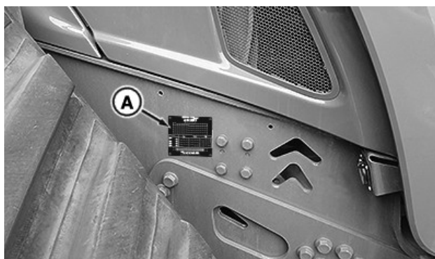
TOOTE IDENTIFITSEERIMISNUMBRI PLAAT (A) ASUB TRAKTORI RAAMI PAREMAL KÜLJEL
