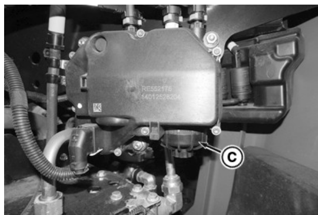
Filtret til DEF-doseringsenhed (C) er i batterirummet i bunden af DEF-doseringsenhed.
