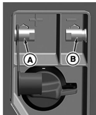
RXA0187645—UN—10AUG22 Batteriets koblingskabelklemmer er placeret i nærheden af traktorens trin.
