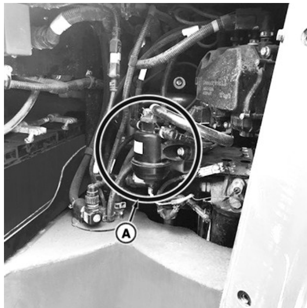
RXA0163952—UN—24JUL18 Il filtro in linea DEF (A) si trova all'interno del vano batteria.
